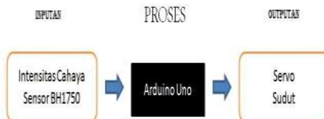
Proses kerja sistem optimasi daya output pada photovoltaic solar menggunakan
