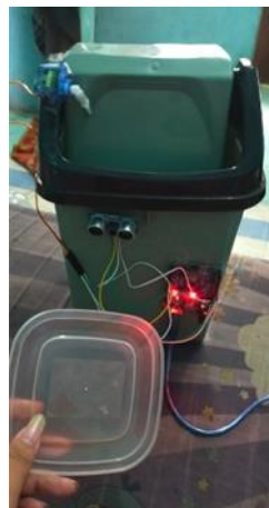
Gambar 7 Motor Servo Akan Tertutup Setelah 10 Detik
