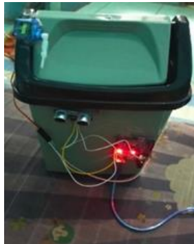
Gambar 6 Tempat Sampah Ketika Mendeteksi dan Motor Servo Akan Terbuka
