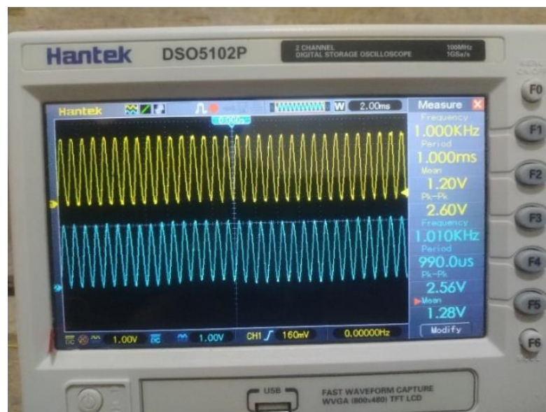
Gambar 8. Hasil Uji Mikrofon Frekuensi 1 KHz
