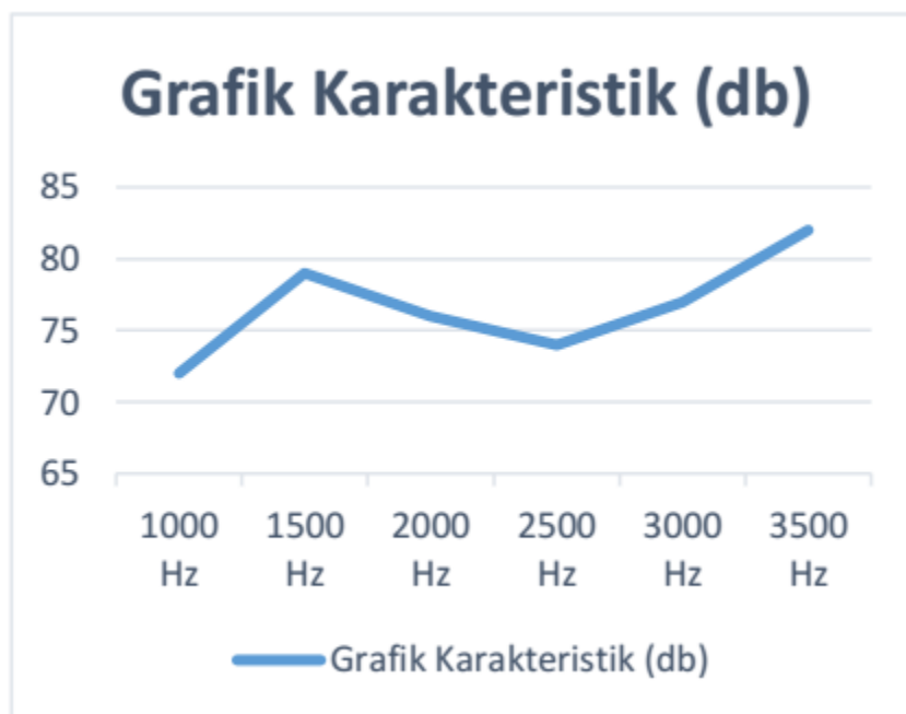
Gambar 3. Grafik Karakteristik Sensor Suara FC-04
