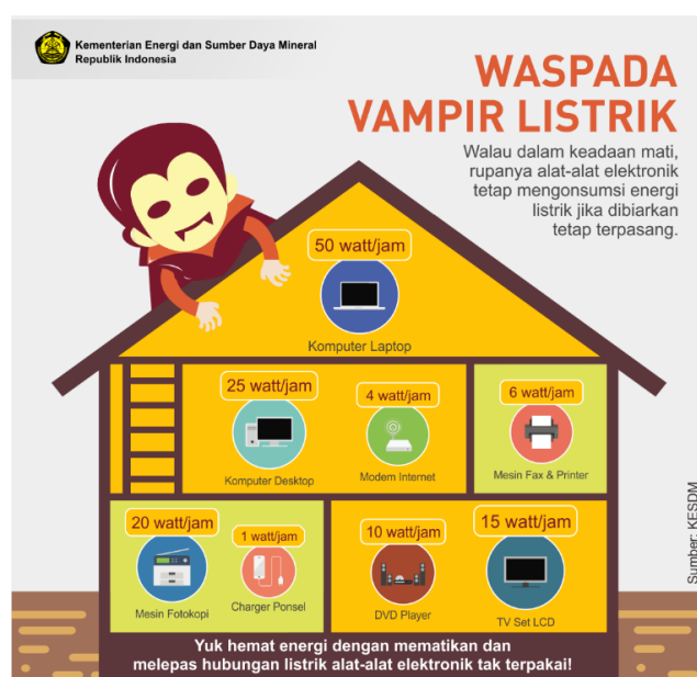
Gambar 1. Besar daya yang terbuang dari peralatan listrik dalam keadaan standby
