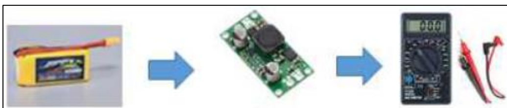
Gambar 5. Diagram blok pengujian catu daya step down regulator
