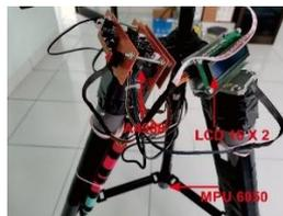
Gambar 7. Penempatan Komponen Tripod
