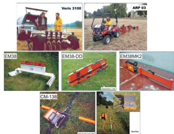
Gambar 3. Instrumen pengukur EC yang sudah banyak digunakan di lahan pertanian (Lück et al. , 2009)
